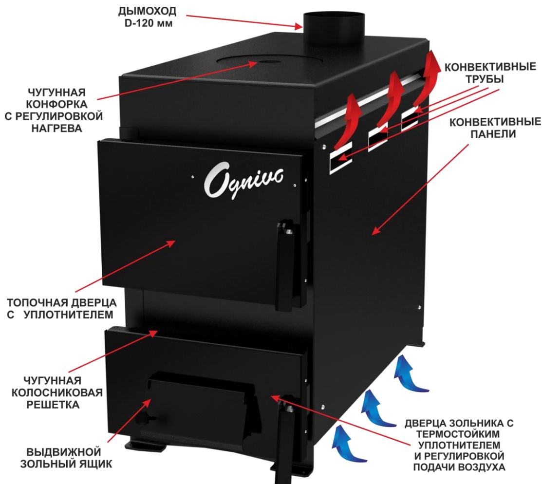
Печь можно эксплуатировать в различных режимах теплоотдачи - от интенсивного до экономичного (длительного). При использовании режима длительного горения рекомендуется использовать шиббер-заслонку (приобретается отдельно) и подачу первичного воздуха через зольный ящик. Совместное использование **шиббер-заслонки и регулируемой подачи воздуха через зольную дверцу** поможет достичь оптимального значения режима работы длительного горения.
